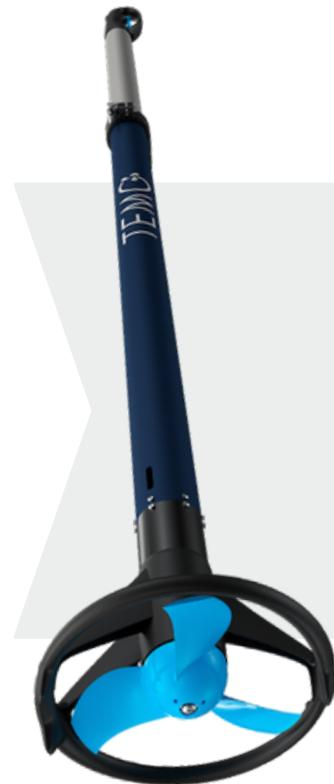
**Diametro del propeller a 3 pale:** 17,5 cm
